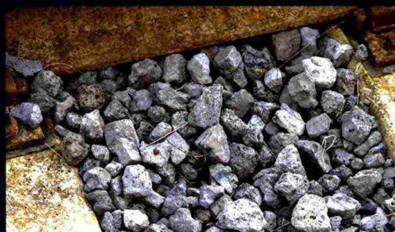
A lato: i due binari sotto monitoraggio per il progetto "Ecoballast"; a sinistra quello con le traversine affogate nella massicciata proveniente dalle scorie siderurgiche. In basso: particolare del ballast in corso di test, più scuro e poroso delle pietre utilizzate attualmente.
